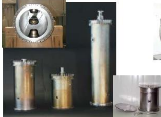
Résonateurs quart d'onde (ALPI, Legnaro) 80 à 352 MHz - \beta = 0,047 à 0,25
