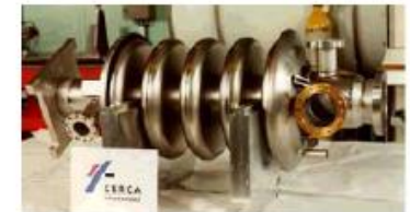
Cavité APT (Los Alamos) 700 MHz - \beta = 0,64
