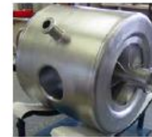
Cavités spoke (CNRS Orsay) 352 MHz - \beta = 0,15 et 0,35
