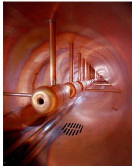
Fermilab DTL : -> 116 MeV, 425 MHz
